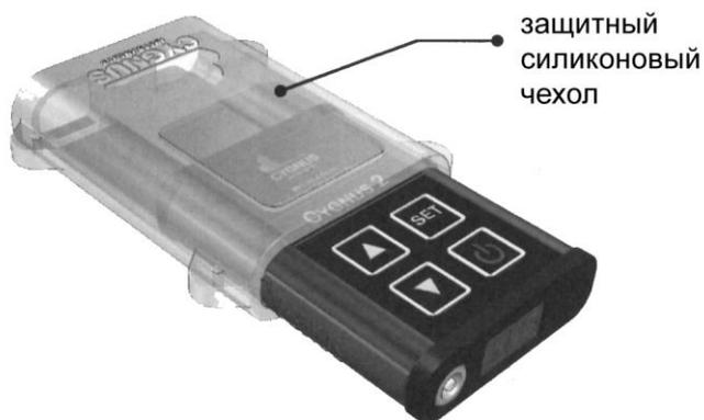
Чтобы вытащить измеритель вытолкните его нижнюю часть.
