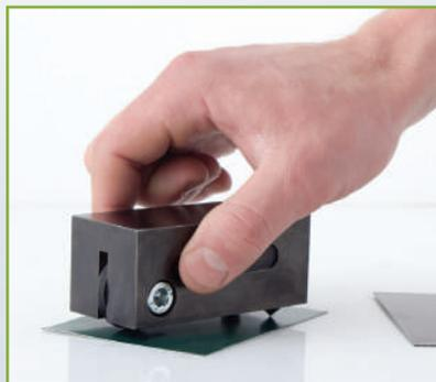
Твердость по Бухгольцу определяется как способность покрытия сопротивляться внешнему механическому воздействию в соответствии с DIN EN ISO 2815. Также метод измерения твердости регламентирован ГОСТ 22233-2001 и рекомендован для определения твердости защитных покрытий алюминиевого профиля.
