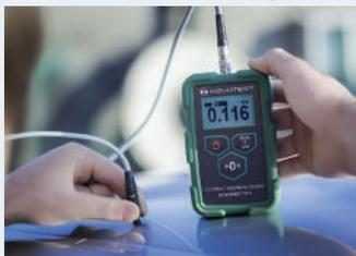
Набор предназначен для контроля различных параметров покрытия таких как: толщина, адгезия, твердость, прочность, температура, глубина дефекта. В состав набора входит\*: толщиномер покрытий ТП-1, адгезиметр АЦ-1, адгезиметр АР, твердомер покрытий карандаш ТПК-1, механический глубиномер очаговой коррозии ДОПУСК С-3, калькулятор точки росы КТР-1, измеритель прочности покрытий при ударе УДАР Универсал.
