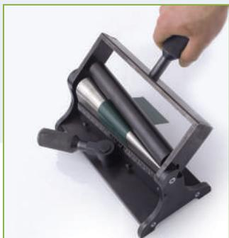
Прибор представляет собой станину, в которой неподвижно установлен стержень в виде усеченного конуса. В подвижной рамке с рукояткой установлен тянущий стержень, с помощью которого осуществляется изгиб образца вокруг конуса. Испытуемый образец фиксируется в приборе зажимом. За прочность принимается минимальный диаметр стержня, на котором не произошло растрескивание или расслоение покрытия (определяется по шкале прибора, дополнительные расчеты не требуются).
