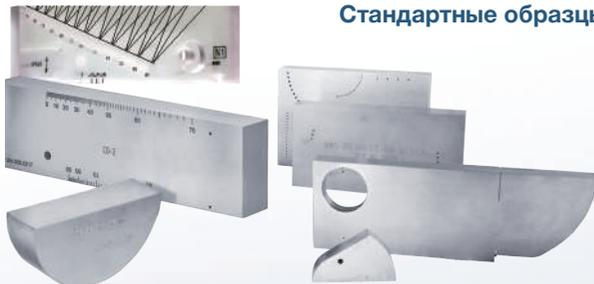
Стандартные образцы СО-1, СО-2, СО-3, V1, V2 и др. предназначены для настройки, проверки работоспособности и калибровки оборудования ультразвукового контроля. Производятся по стандартам: ГОСТ 14782; ГОСТ 18576; ТУ 25-06.1847-78; ДСТУ 4001-2000; (DIN 54120, V.S. 2704)
