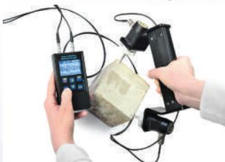
Набор предназначен для контроля прочности и однородности бетона, кирпича, различных растворов, определения толщины защитного слоя бетона, определение наличия арматуры и ее диаметра. В состав комплекта входит\*: измеритель прочности строительных материалов ИПСМ-У+Т+Д, арматуроскоп, склерометр МШ-225/75/20, штангенциркуль, рулетка, линейка, фонарик.
