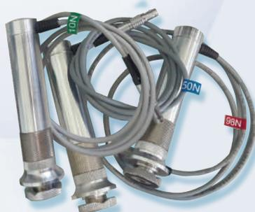
Разборная насадка позволяет производить контроль деталей сложной формы.
