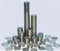
Данный комплект предназначен для проверки работоспособности, настройки и калибровки ультразвуковых толщиномеров в условиях предприятий-изготовителей. Комплект стандартных образцов толщины КУСCOT-180 применяется также при проведении поверки, калибровки и метрологической аттестации ультразвуковых толщиномеров.
