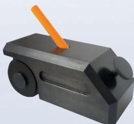
Прибор предназначен для определения твердости покрытий и устойчивости покрытий к повреждению царапаньем.
