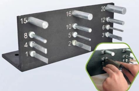
Прибор измеряет эластичность и прочность покрытий при изгибе вокруг набора цилиндрических стержней.
